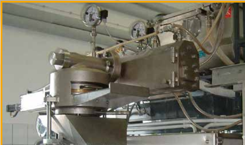
particolare Pressa 500 Kg a doppia testata detail of 500 kg double head Extruder détail de la Presse à 500 Kg à double tête
