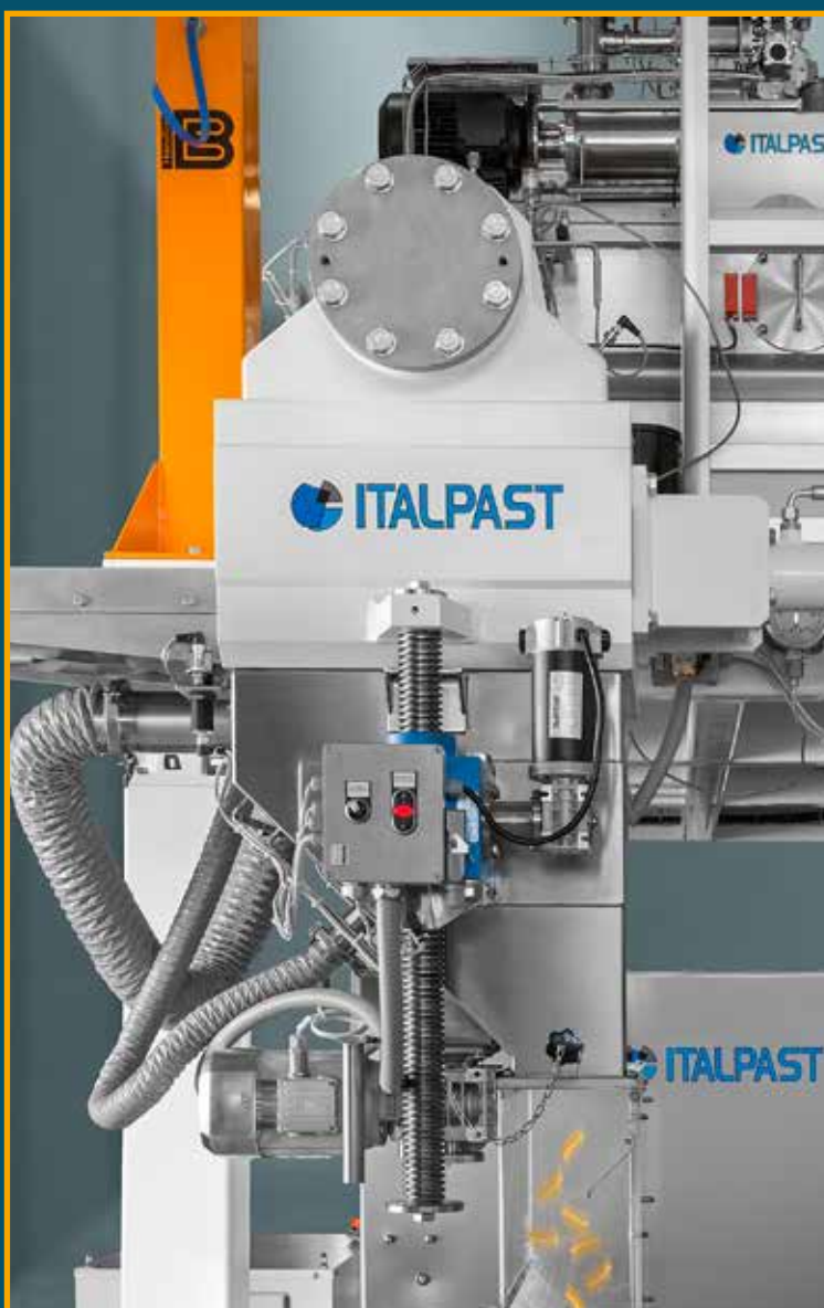
testata circolare e gruppo tagliapasta circular head and pasta cutter group tête ronde et groupe coupe-pâtes
