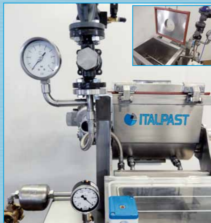
Particolare Impastatrice versione speciale con cottore a vapore adatta per farine crude (no pre-gel)
